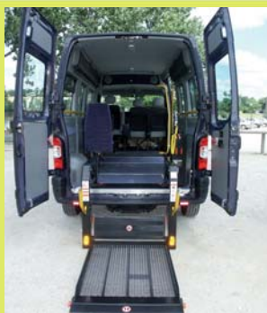
Version HACCESS : accès arrière par hayon élévateur homologué "Handicap"
