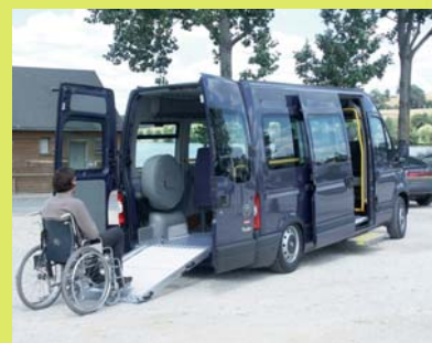
Version HACCESS PLUS: abaissement de la suspension pneumatique
