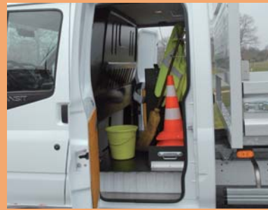
Coffre 1,7 m 3 - Cloison complète étanche et tôle de protection de vitre AR.
