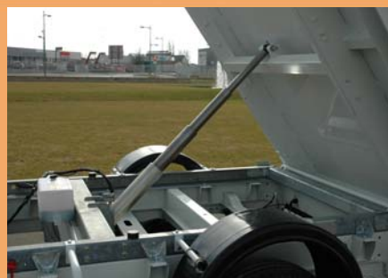
Faux châssis en acier galvanisé boulonné sur le porteur.
