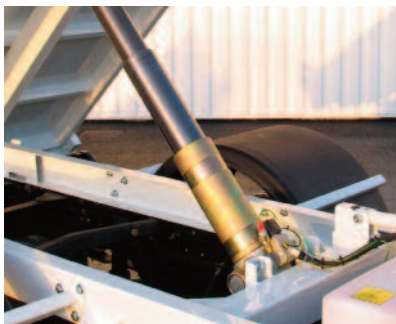
Vérin équipé de clapet parachute piloté, conforme à la norme AFNOR R17-109
