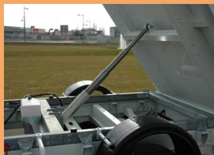
Faux châssis en acier galvanisé boulonné sur le porteur.
