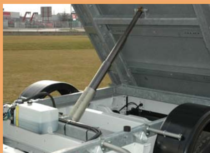
Vérin télescopique 3 corps avec tige chromée
