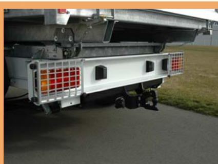
Protection des feux arrière et crochet mixte avec attelage
