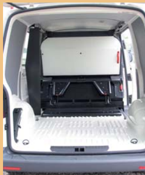
Cloison pour protéger les passagers et accès sous banquette pour les objets longs.
