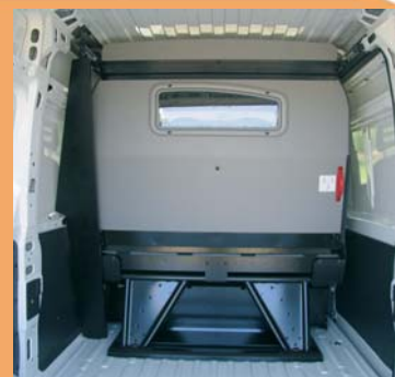
Cloison pour protéger les passagers et accès sous banquette pour les objets longs
