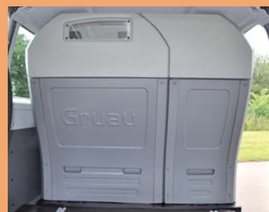
Coque rigide à l'arrière des sièges assurant la séparation avec le chargement.
