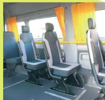
Parois avec main courante sous ligne de baie et protection anti-chocs en partie basse à l'aide d'une plinthe inox.
