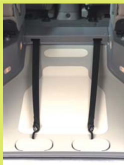
Fauteuil roulant retenu à l'avant et à l'arrière par 4 sangles d'ancrage à enrouleur à verouillage électrique
