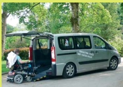
Version Haccess Plus : rampe manuelle courte et abaissement automatique du véhicule
