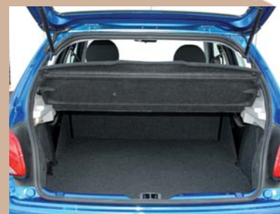
Option tablette cache-bagages repliable type accordéon positionnée derrière celle d'origine.
