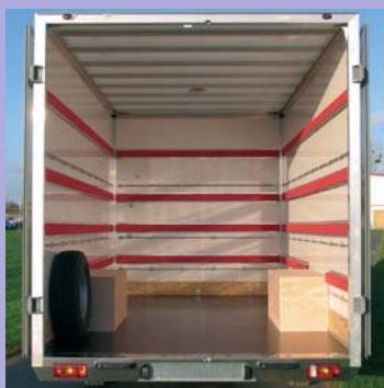
Aménagement meuble Passage de roues en CP
