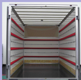
Aménagement meuble 4 capotons et 3 barres d'arrimage Pavillon opalescent
