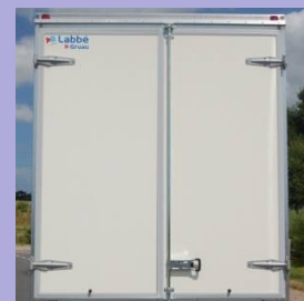
Tringlerie et poignée en appliques Feux de gabarit haut de caisse
