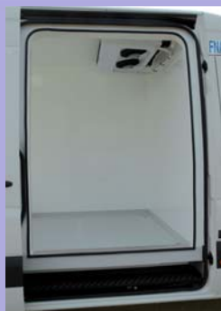
Contre-porte isotherme fixée sur la porte latérale d'origine
