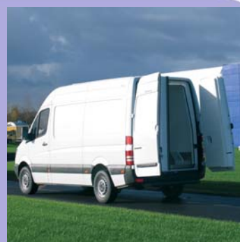
Contre-portes isothermes fixées sur les portes arrière d'origine
