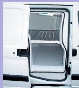
Isolation des ouvrants d'origine par des contre-portes isothermes
