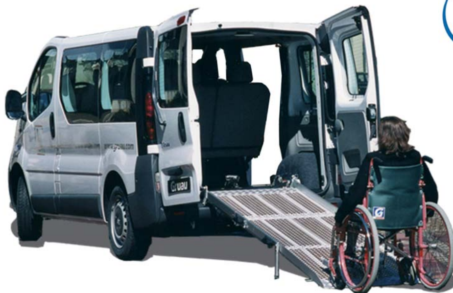
Version STHANDY : rampe manuelle légère et assistée, relevable en 3 parties.
