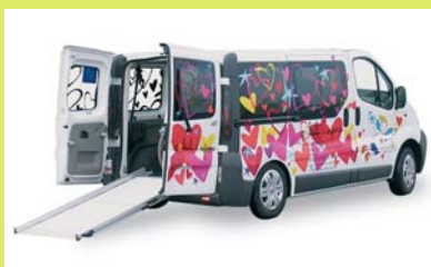
Version Haccess Plus en option : rampe manuelle courte et abaissement automatique du véhicule
