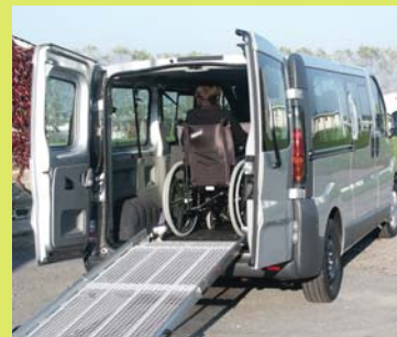
Accès de la personne en fauteuil roulant par les portes arrière
