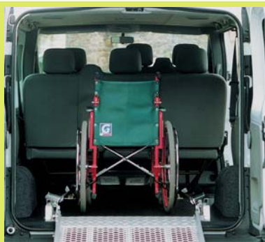
Fixation du fauteuil roulant par sangles d'ancrage à enrouleur, montées sur rails
